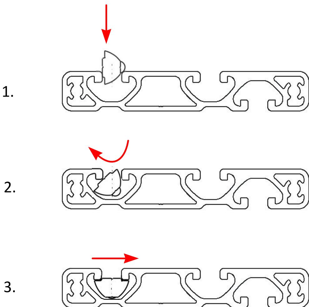
(NL) Om de glijmoer eruit te halen, duw je erop, draai deze naar de positie zoals in tekening 2. Dan kan je de glijmoer rechtrekken, met je vingers, met een bektang of met een sterke magneet.
